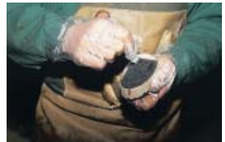
Dritter Schritt: Kleber in Gitterform auf den Klotz aufbringen. Wenn der Klebstoff auf dem Klotz ist, muss es schnell gehen.
